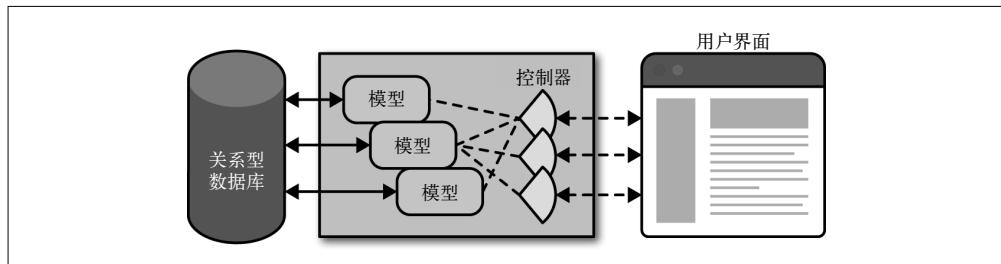
图 7-1：传统的应用程序架构
